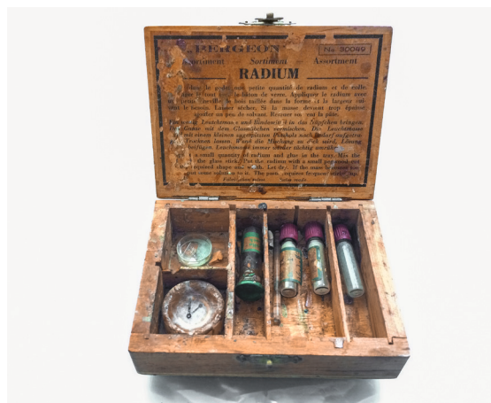
Set di pittura luminescente storico. Contiene sale di radio, solfuro di zinco e colla, oltre a una ciotola di miscelazione. In questa ciotola, le sostanze sono state mescolate con l'acqua per formare la pittura luminescente.
