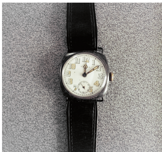
Orologio da polso contenente pittura luminescente con Ra-226. L'intensità di dose di simili orologi è di circa 15 µS/h al contatto.
