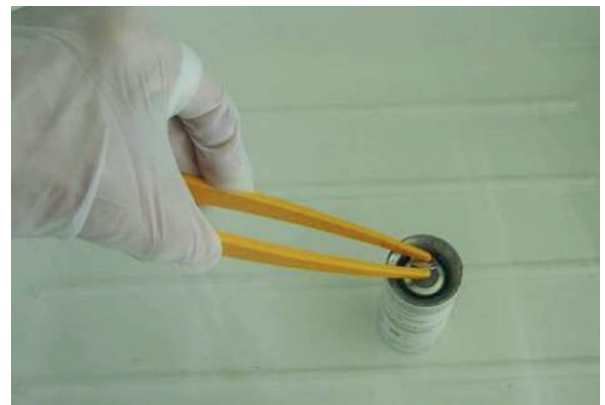
Fig. 11: Rimozione del cappuccio di protezione del setto mediante pinzette
