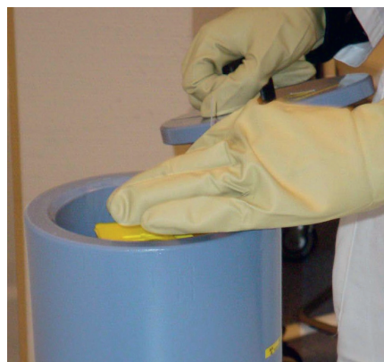
Abb. 15: Contenitore rifiuti per materiale contaminato
