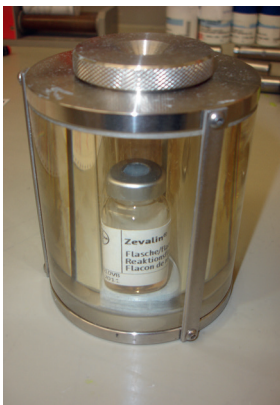
Fig. 9: Schermatura per flaconi
