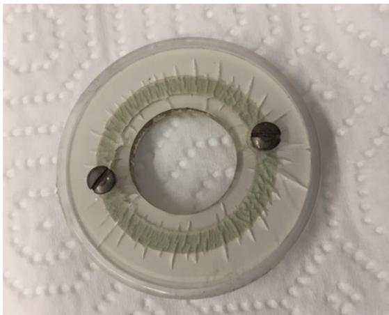
Fig. 7: Interruttori della luce con pittura luminescente contenente Ra-226
