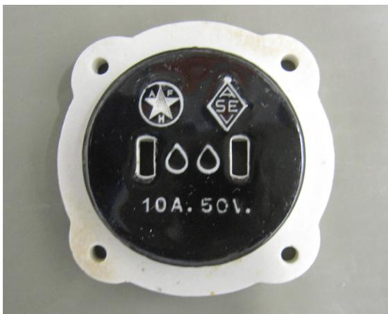
Fig. 8: Presa elettrica a basso voltaggio con pittura luminescente contenente Ra-226
