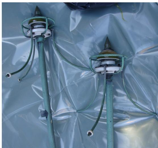
Fig. 10: Parafulmine con Ra-226 rimosso, fotografia ravvicinata
