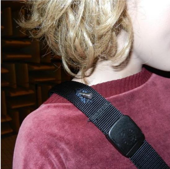
Abb. 27: ¼"-Mikrofon-Befestigung mit dem Norsoinc 131
