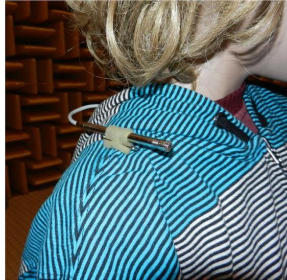
Abb. 28: ¼"-Mikrofon-Befestigung mit dem B&K 4135 / 4165
