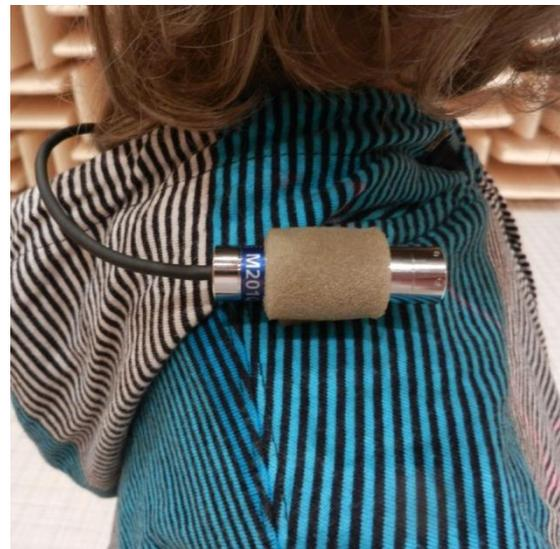
Abb. 26:  $\frac{1}{2}$ "-Mikrofon-Befestigung mit dem NTi Audio XL2
