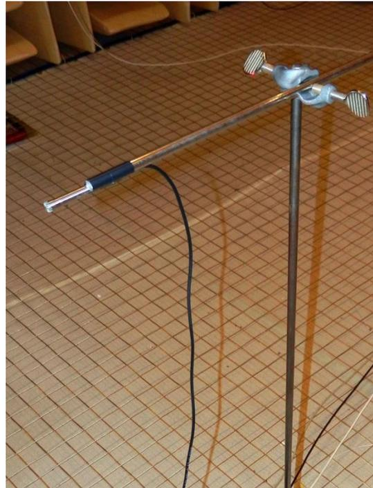
Abb. 20: Detail-Ansicht der Mikrophon-Halterung ohne Puppe
