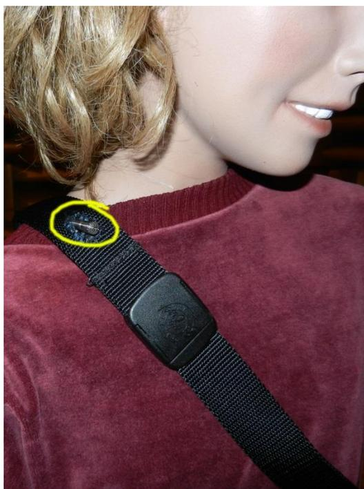
Abb. 18: Befestigung des 1/4 " Mikrophons auf der Schulter
