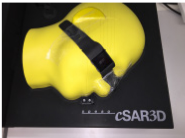
Figura 1 Fantoccio piatto di una testa con smartwatch
