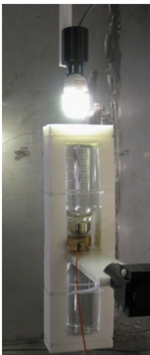
Figura 2: fantoccio con liquido sottoposto al campo elettrico di una lampadina a basso consumo energetico. Le correnti indotte nel fantoccio vengono misurate con l'aiuto del morsetto posto al centro. La distanza tra la lampadina e il fantoccio è di circa 2 cm [2]
