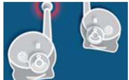
Alcuni apparecchi controllano costantemente se il ricevitore si trova ancora entro la portata del trasmettitore. A tale scopo, l'unità bambino invia un breve segnale di prova a intervalli di pochi secondi ed emana quindi delle radiazioni.
