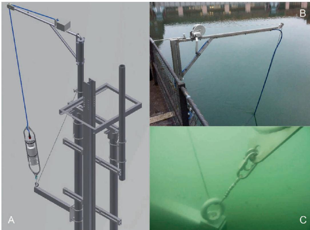
Figure 3: Installation d'une sonde aquatique sur un pilier planté dans l'eau (A); Une potence fixée sur la rive (B); Fixation inférieure de la sonde (C). Le câble de raccordement bleu et le câble d'acier porteur sont conduits dans l'eau via la potence. Le câble d'acier inférieur sert à positionner et renforcer la sonde (image A: D. Wyder, Metas; image C: taf-taucharbeiten ag).
