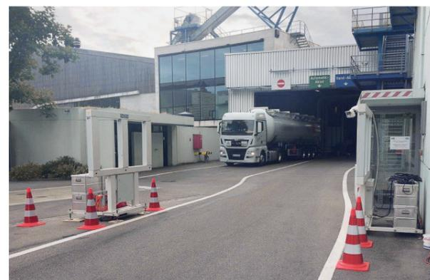
Fig. 8 : Portique de mesure à l'entrée de la zone de déchargement des déchets de l'usine d'incinération des ordures ménagères de Bâle
