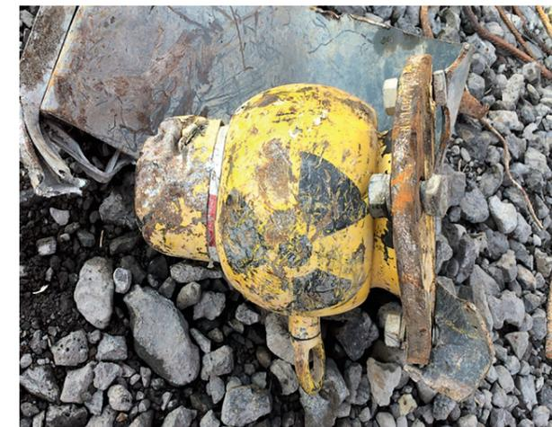
Fig. 10 : Découverte d'une source radioactive de cobalt 60 dans de la ferraille
