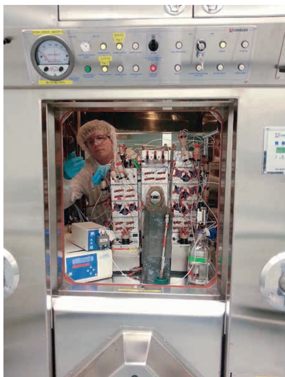
Figure 8: chercheur travaillant à la synthèse de nouveaux produits radiopharmaceutiques devant les cellules chaudes blindées de la salle blanche du laboratoire de l'EPFZ
