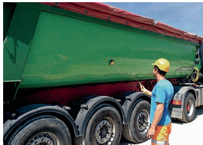
Figure 9: mesures de radioactivité sur place lors du retrait du matériel de la décharge
