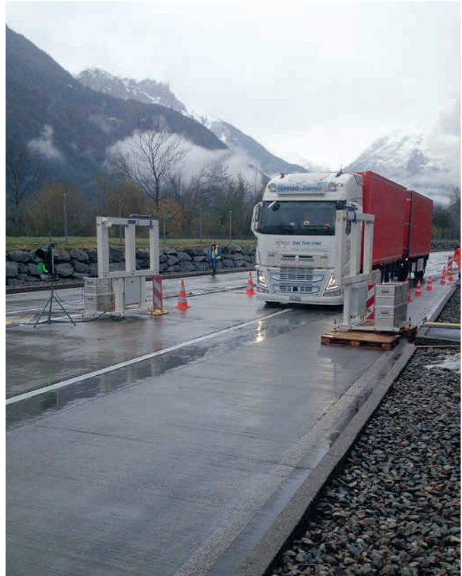
Figure 6: essai du portique de mesure : contrôle d'un poids lourd concernant le transport illégal de substances radioactives
