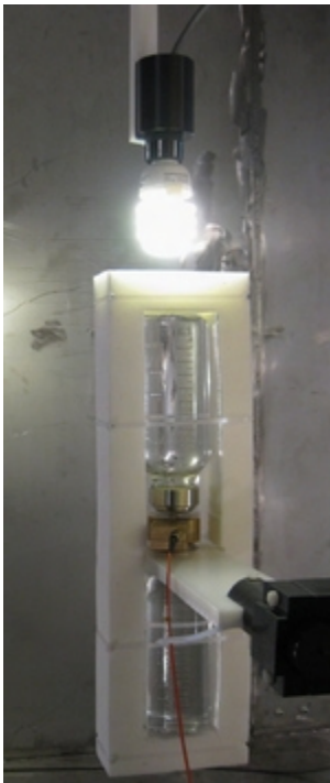
Figure 2 : Fantôme contenant du liquide, placé dans le champ électrique émis par la lampe à économie d'énergie. Les courants induits dans le fantôme sont mesurés au moyen de la pince fixée au milieu. La distance entre la lampe et le fantôme est de 2 cm [2].
