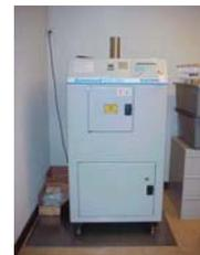
Beispiel: Blutbestrahlungsanlage mit 50 TBq Cs-137 (ca. 1400 Ci)
