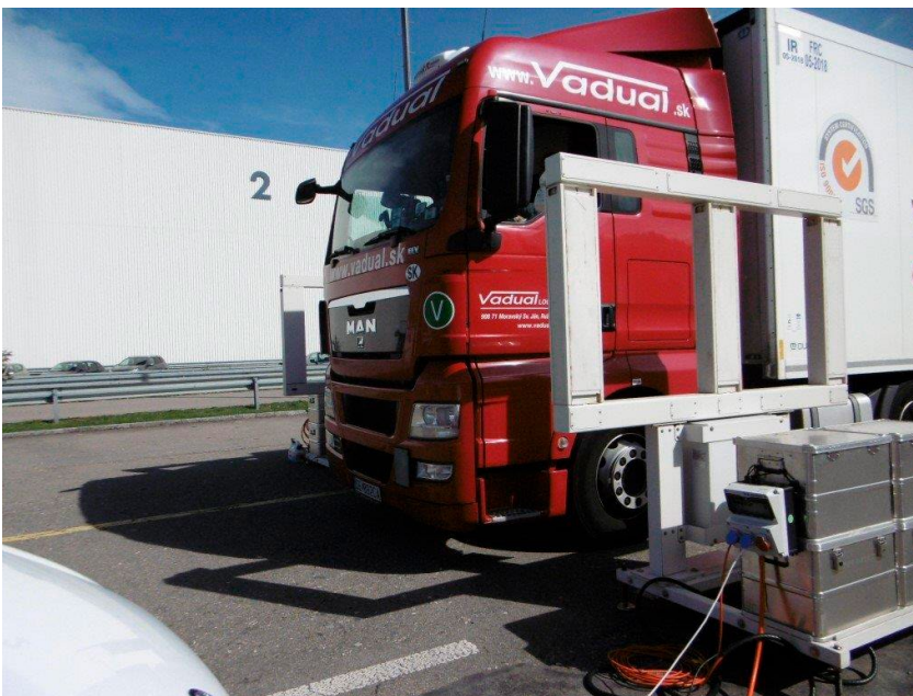
Abb. 6 Das BAG führt regelmässig Schwerpunktkontrollen an Zollstellen oder Schwerkverkehrszentren durch. Dabei wird dieses weisse Messportal eingesetzt, das beidseitig der Strasse aufgestellt wird und vorbeifahrende Fahrzeuge auf Radioaktivität überprüft.
