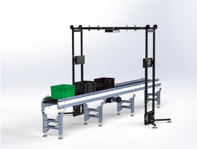
Abb. 5 Weil bei Messungen in Paketzentren regelmässig Pakete mit erhöhter Dosisleistung auftauchen, hat das BAG eine spezifische Messeinrichtung bestellt, die über einem Förderband installiert werden kann. Damit können Pakete mit radioaktivem Inhalt direkt identifiziert werden. Dieses Messgerät wird in diversen Paketzentren und bei Kurierdiensten zum Einsatz kommen.
