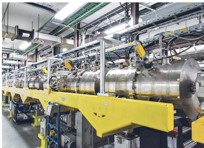
Abb. 6: Tunnel des LINAC 4 mit dem Driftröhren-Modul (Drift Tube Linac, DTL),
