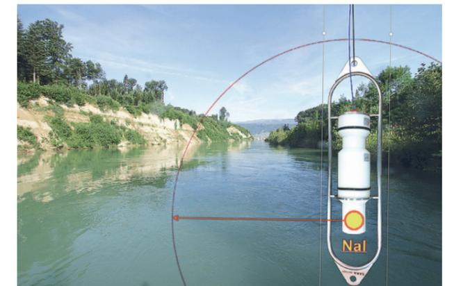
Abb. 16: Die Natrium-Iodid-Kristalle an den Wassersonden registrieren im Umkreis von zirka einem Meter die Gammastrahlung von natürlichen Nukliden und künstlichen Radionukliden
