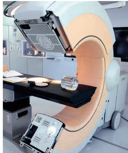
Abb. 2: Messungen zur Qualitätssicherung an einem mobilen Durchleuchtungssystem
