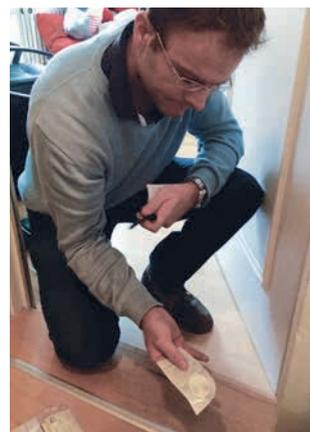
Abb. 12: Wischtest für die Laboranalyse
