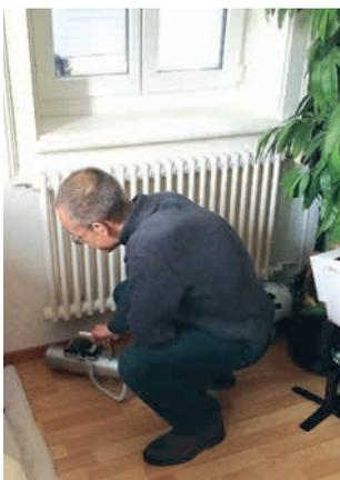
Abb. 11: Messung der Dosisleistung
