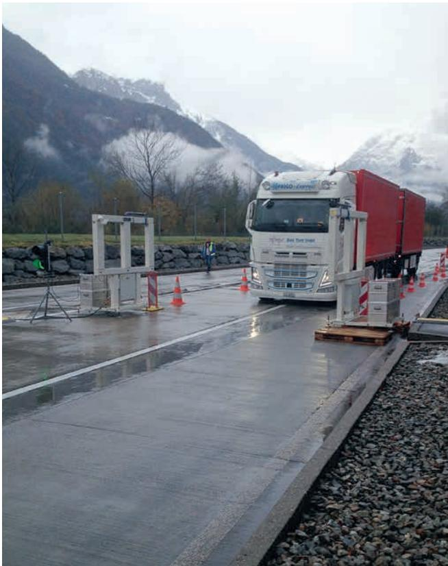
Abb.6: Testlauf am Messportal: Messung eines Lastwagens auf illegale radioaktive Stoffe
