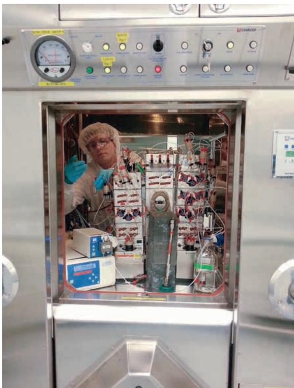
Abb.8: Ein Forscher der ETH Zürich bereitet im Reinluft-Labor das Synthesemodul für die Herstellung neuer Radiopharmaka vor, welches sich innerhalb einer verbleiten Heiss-Zelle befindet
