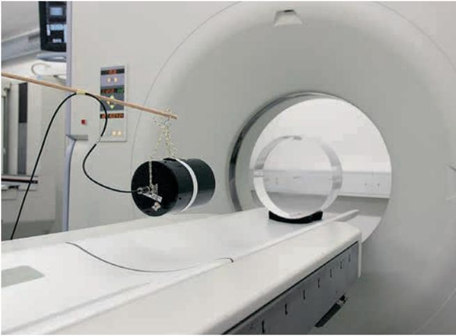
Abb. 3: Messungen der Ortsdosisleistung an einem CT-Scanner
