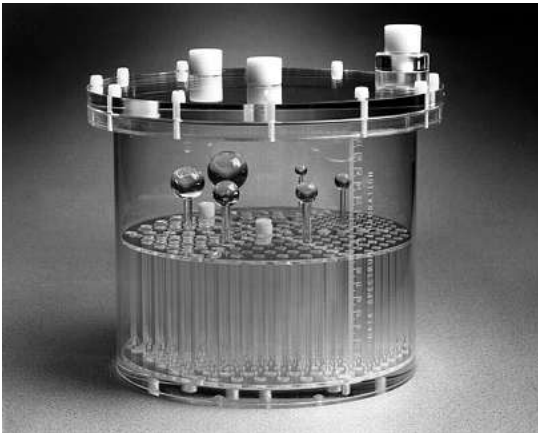
Abb. 4: Jaszczak Phantom zur Überprüfung der Bildqualität an PET- und Spect-Kameras
