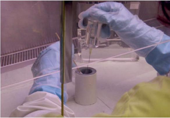
**Abb. 7:** Verwendung von Bleigummihandschuhen zur Reduktion der Handdosen
