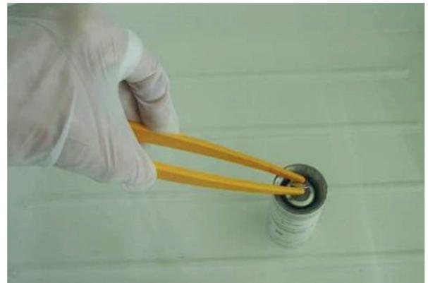
**Abb. 11:** Entfernen der Septen-Schutzkappe mit Pinzette
