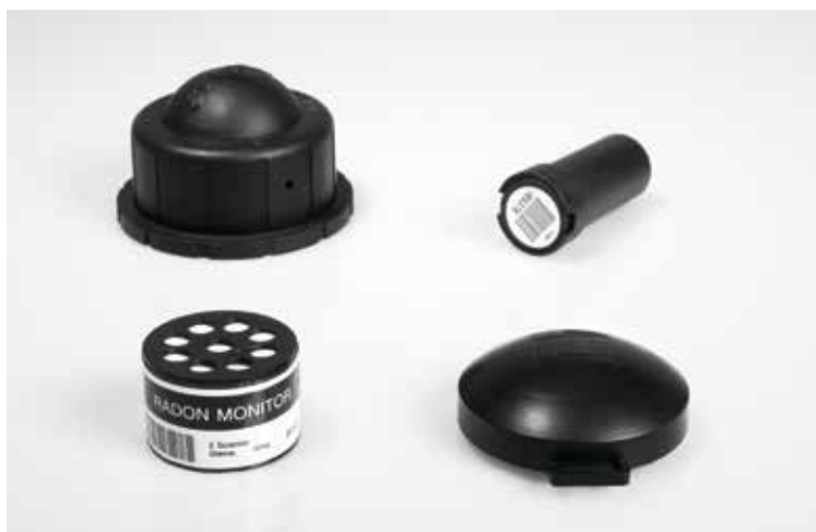
Figura 1.3: I dosimetri per il radon sono più piccoli di un vasetto di yogurt (Fonte: UFSP).
