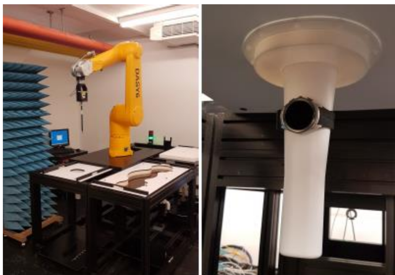
Figura 2 Sistema di misurazione dosimetrica e fantoccio di un braccio con smartwatch
