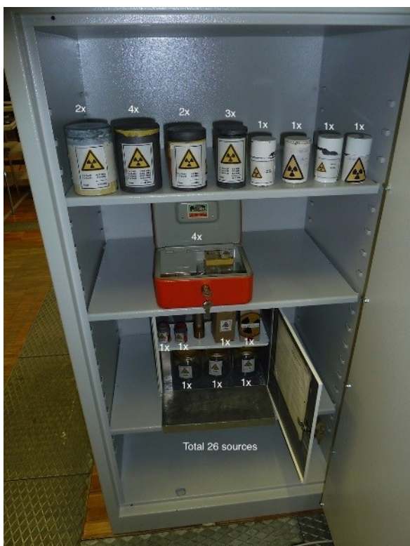
Foto 2: Contrassegno delle sorgenti radioattive: il simbolo di pericolo e le informazioni sul nuclide e sull'attività permettono di identificare rapidamente le sorgenti. Deve essere istituito un sistema che permetta di constatare rapidamente la mancanza di una sorgente.
