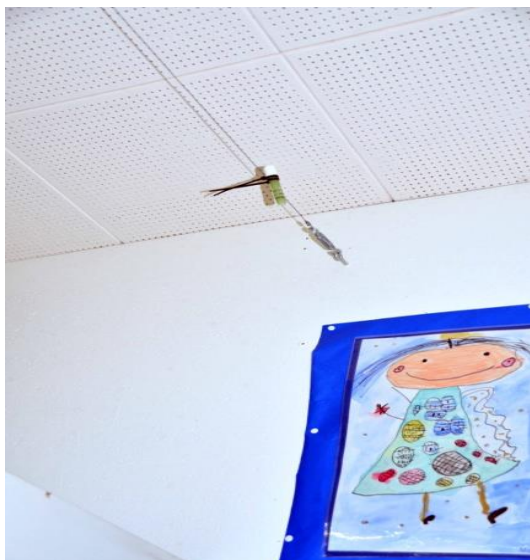
Abb. 6 Passivsammler zur Stickstoffdioxid-Messung
