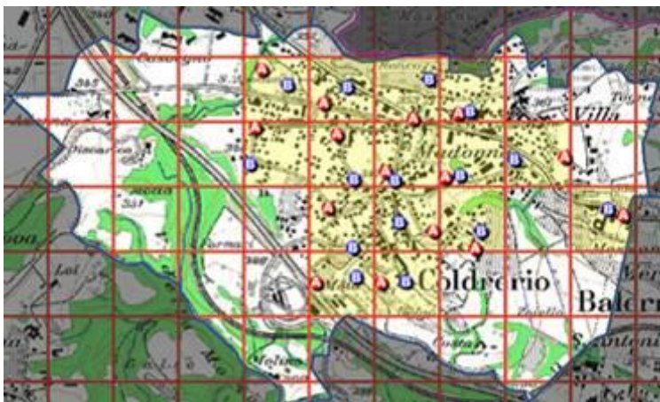
Figura 9: Posizionamento delle ovitrapole per il rilevamento su larga scala delle zanzare Aedes invasive. In una griglia con celle di 250 m x 250 m sono posizionate da una a due ovitrapole (A e B). Le trappole devono essere distanziate almeno 50 m l'una dall'altra, in modo da non influenzarsi reciprocamente. Fonte: SUPSI.
