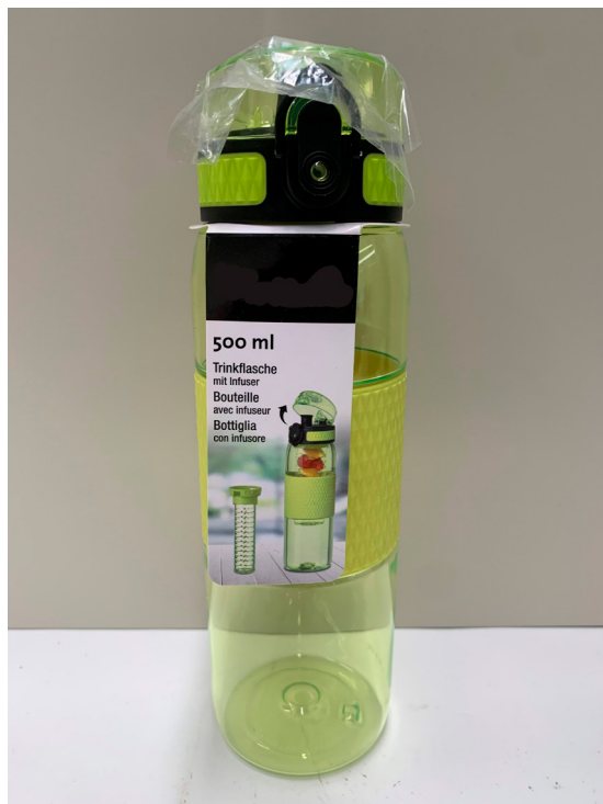
Figure 13 : Les élastiques tendus autour des gourdes pour en faciliter la maniabilité contenaient des matériaux radioactifs naturels (NORM) en quantité supérieure à la limite de libération autorisée pour les NORM.
