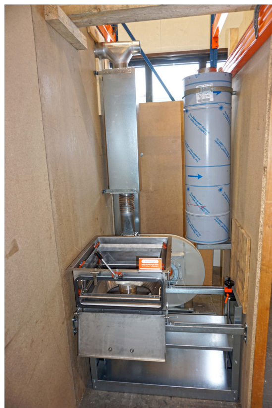
Figure 28 - La machine en cours de fabrication, avec au premier plan le caisson de collecte et en arrière-plan les canaux d'entrée et de sortie d'air équipés d'amortisseurs de bruit ainsi que la pompe.
