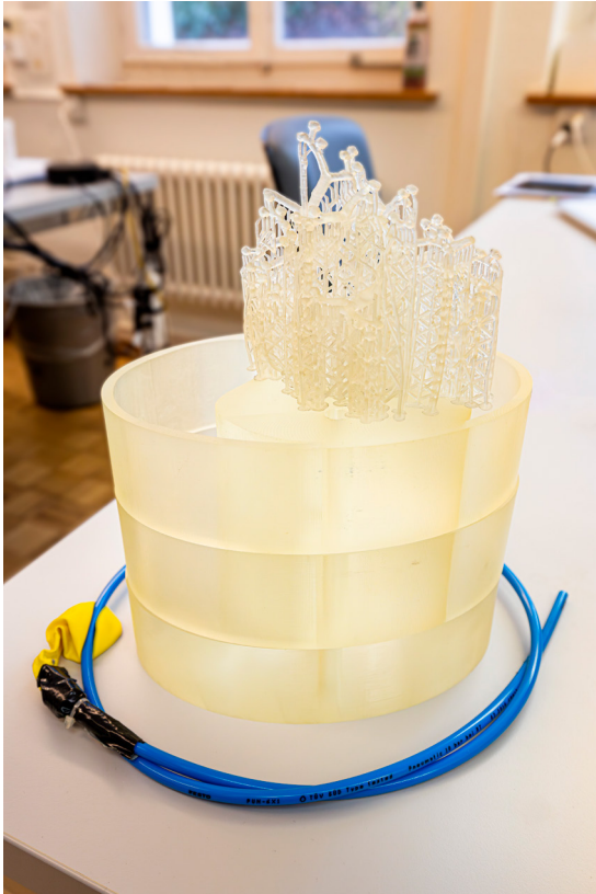
Figure 18 : Fantôme d'un poumon d'enfant (impression 3D réalisée par la Haute école des sciences appliquées de Zurich) ; les fantômes permettent de tester à quelle dose les médecins peuvent encore reconnaître à l'œil nu les structures larges ou fines, proches ou éloignées les unes des autres, voire en mouvement.
