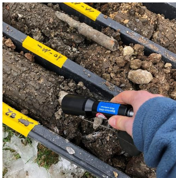
Figure 3 : Mesure du taux de comptage à l'aide d'une petite sonde de mesure de contamination.
