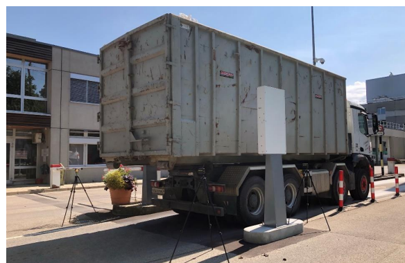
Figure 6 : Portail de mesure pour le contrôle de grandes quantités de matériaux.
