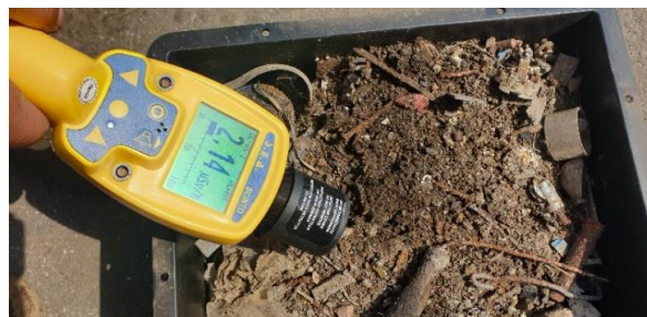
Figure 5 : Mesure à la main de matériaux d'excavation à l'aide d'un instrument de mesure portable du débit de dose. Il peut aussi être utilisé pour localiser les matériaux radioactifs.
