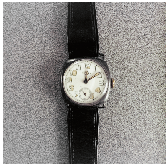
Montre-bracelet contenant de la peinture luminescente au Ra-226. Débit de dose au contact de ce genre de montres est de l'ordre de 15 µS/h.
