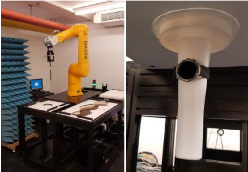
Figure 2. Système dosimétrique et fantôme d'un bras avec une montre connectée
