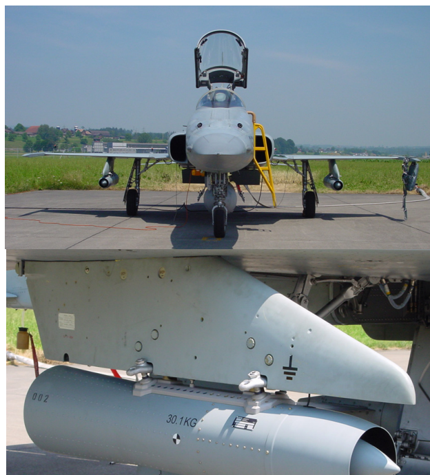
Figur 2: Höhenluftfilter-Aggregate montiert an den beiden Flügeln eines Tiger sowie Detail-Aufnahme eines Sammelgerätes.
