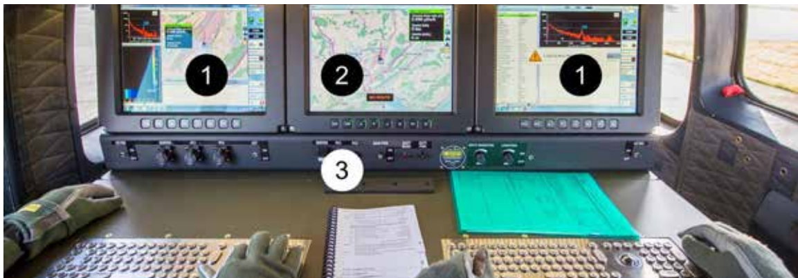
Abbildung 2: Operateur-Konsole des Aeroradiometriesystems. 1: Bildschirme der Bedienkonsole; 2: Bildschirm (gespiegelt auf Bildschirm im Cockpit); 3: Bedienfeld mit Schaltern für Stromversorgung, Beleuchtung und Kommunikation sowie Schnittstellen für den Datentransfer.
