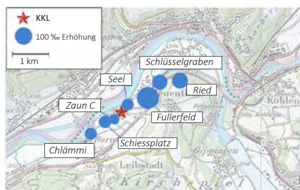
Figur 2: Netto \Delta^{14}\text{C} -Messwerte in der Umgebung des Siedewasserreaktors Leibstadt (KKL) im Jahr 2024. Revisionsabschaltung: 29.04.2024 bis 31.05.2024. Probenahme: 19.09.2024. Die Kreisflächen sind proportional zur Erhöhung gegenüber den unbelasteten Referenzstationen.
