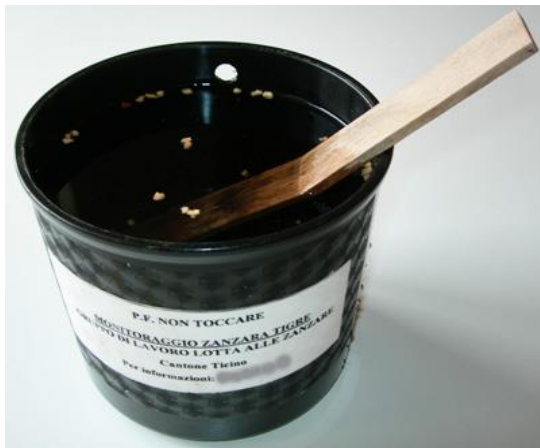
Figure 8 : Ovitrap. L'« ovitrap » se prête bien à la collecte des œufs d'espèces invasives de moustiques du genre Aedes . Les femelles pondent leurs œufs sur les petits bouts de bois qui sortent de l'eau. Ceux-ci sont collectés et examinés au laboratoire pour analyser les œufs présents. Pour éviter que l'ovitrap ne devienne lui-même un gîte larvaire, des granulés contenant du Bti sont placés dans le piège pour tuer les éventuelles larves. Source : SUPSI
