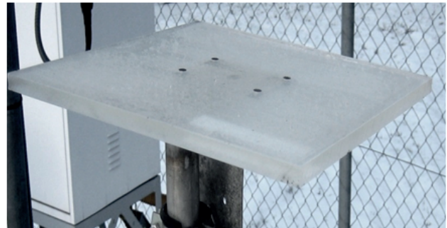
Figur 1: Staubfangplatte am Zaun des ZWILAG-Areals.
