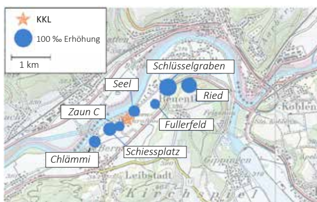
Figur 2: Netto \Delta^{14}\text{C} -Messwerte in der Umgebung des Siedewasserreaktors Leibstadt (KKL) im Jahr 2023. Revisionsabschaltung: 01.05.2023 bis 31.05.2023. Probenahme: 14.09.2023. Die Kreisflächen sind proportional zur Erhöhung gegenüber den unbelasteten Referenzstationen.
