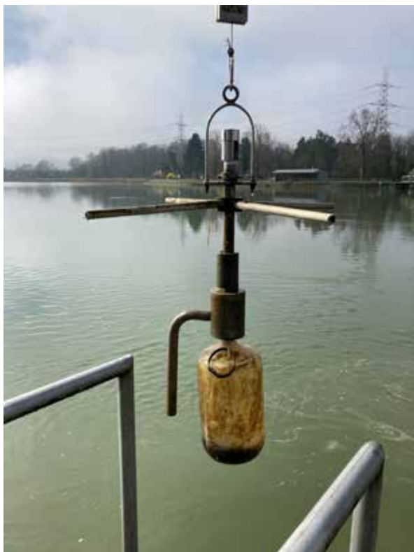
Figur 1 : Probensammler für Flusswasserproben der Zwiilag, des KKB und PSI. Foto: Patricia Kramer.
