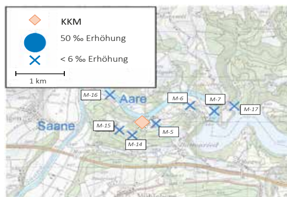
Figur 6: Netto \Delta^{14}\text{C} -Werte in der Umgebung des Siedewasserreaktors Mühleberg (KKM) im Jahr 2023. Probenahme: 07.09.2023. Mit Ausnahme des Standorts Uferm Horn wurde an keinem Standort eine Erhöhung gegenüber den unbelasteten Referenzstationen festgestellt.
