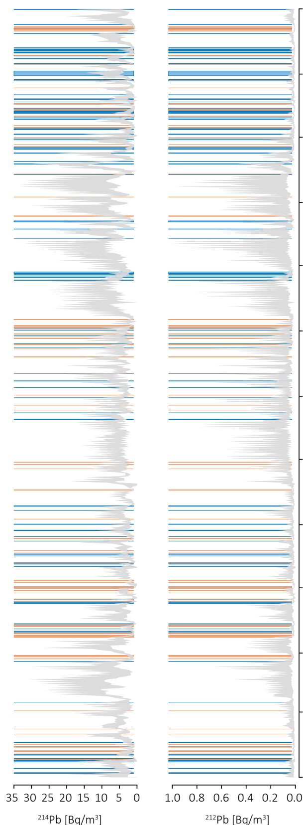
Abbildung 3: Bandbreite der Aktivitätskonzentrationen von ^{214}\text{Pb} und ^{212}\text{Pb} (12h-Mittelwerte) der URAnet aero Stationen auf der Alpennordseite. Markiert sind ebenfalls die Perioden mit Niederschlag (blau) und höheren Windgeschwindigkeiten (orange)
