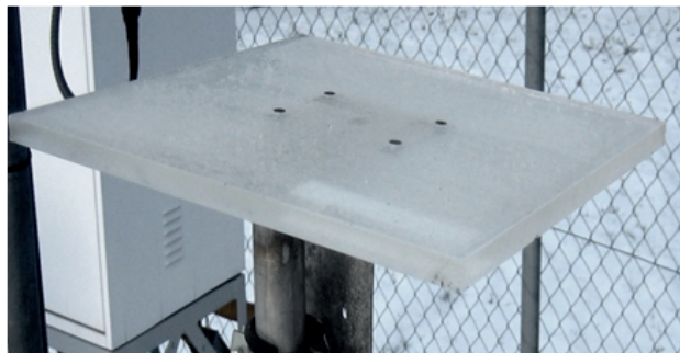
Figur 1: Staubfangplatte am Zaun des ZWILAG-Areals.
