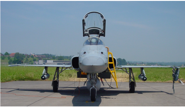
Figur 1 & 2: Höhenluftfilter-Aggregate montiert an den beiden Flügeln eines Tigers sowie Detail-Aufnahme eines Sammelgerätes.
