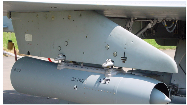
Figur 1 & 2: Höhenluftfilter-Aggregate montiert an den beiden Flügeln eines Tigers sowie Detail-Aufnahme eines Sammelgerätes.
