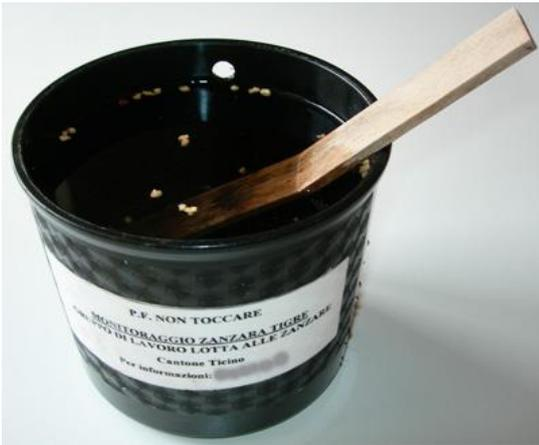
**Abbildung 8:** Ovitrap. Die «Ovitrap» eignet sich, um Eier von invasiven Aedes-Mücken zu sammeln. Die Weibchen kleben ihre Eier auf das aus dem Wasser ragende Holzstäbchen. Dieses wird eingesammelt und im Labor auf vorhandene Eier untersucht. Damit die Ovitrapps nicht selbst zu einer Brutstätte werden, wird die Falle mit einem Bti-haltigen Granulat versetzt, dass allfällige Larven abtötet. Quelle: SUPSI.
