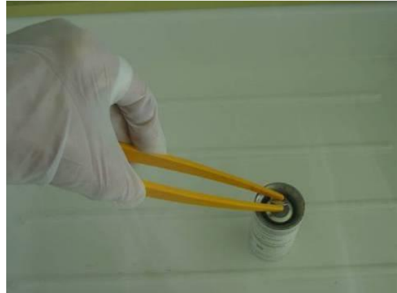
Fig. 11: Rimozione del cappuccio di protezione del setto mediante pinzette
