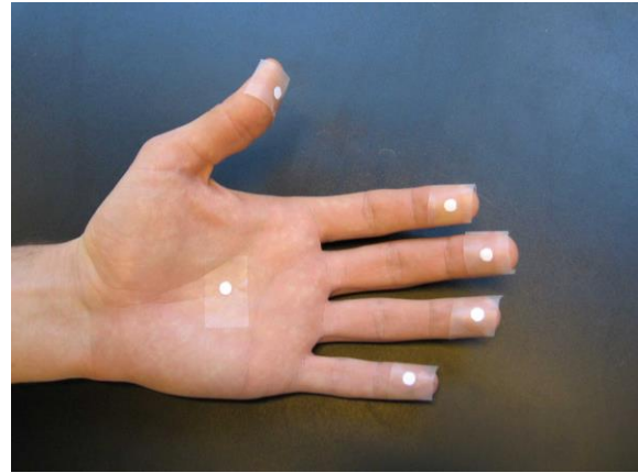
Fig. 2: Misurazione TLD della punta delle dita e della superficie palmare della mano
