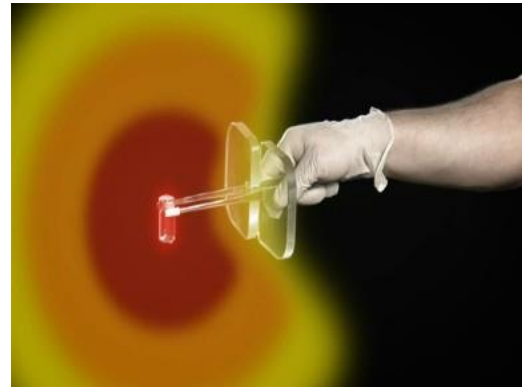
Fig. 4: Pinzette con schermatura in plexiglas
