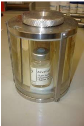
Fig. 9: Schermatura per flaconi
