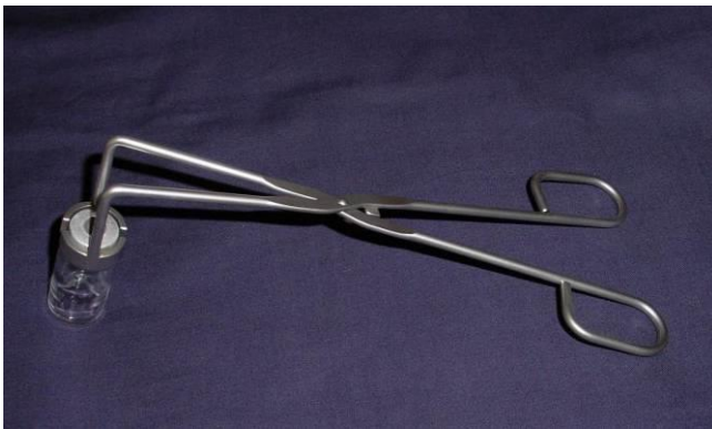
Fig. 3: Pinza per flaconi
