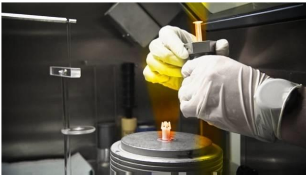
Fig. 14: Prelievo dell'attività dal contenitore di F-18
