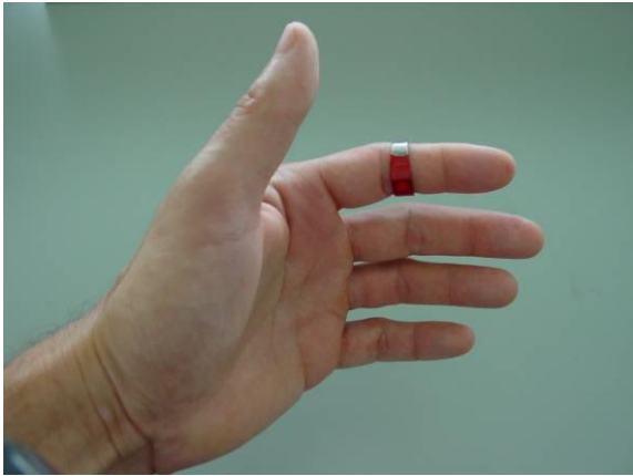
Fig. 1: Modalità per l'utilizzo del dosimetro al dito
