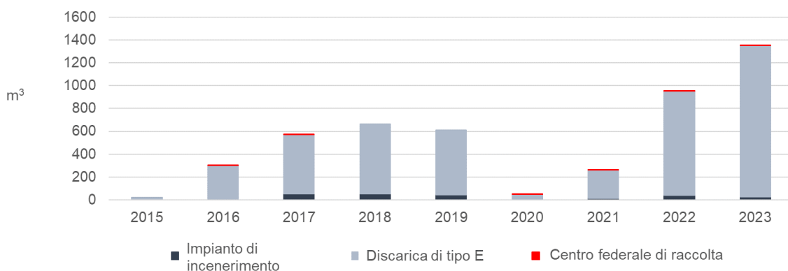
Figura 14: Evoluzione delle quantità di rifiuti provenienti da risanamenti (in m³) smaltiti tra il 2015 e il 2023 secondo la filiera di smaltimento
