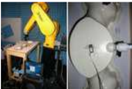
Figura 2: apparecchiatura di misurazione del valore TAS. A sinistra: tavolo di misurazione con il manichino steso nonché il robot di posizionamento e la sonda di misurazione applicata su di lui. A destra: il manichino con il trasmettitore Bluetooth, visto dal basso. Fonte delle immagini [3].
