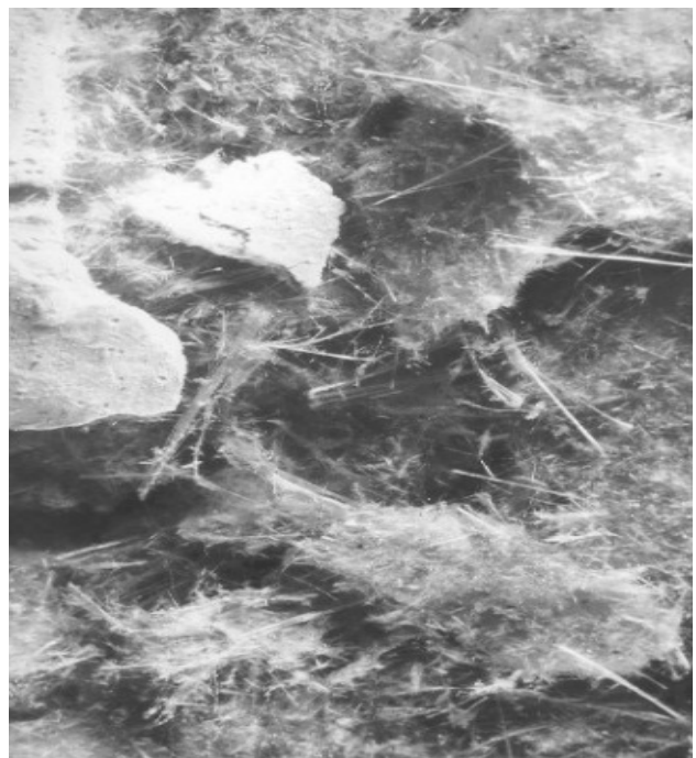
Ingrandimento di un floccato d'amianto con fibre di lana minerale e ciuffi di fibre d'amianto lunghe e appuntite, foto: SA
