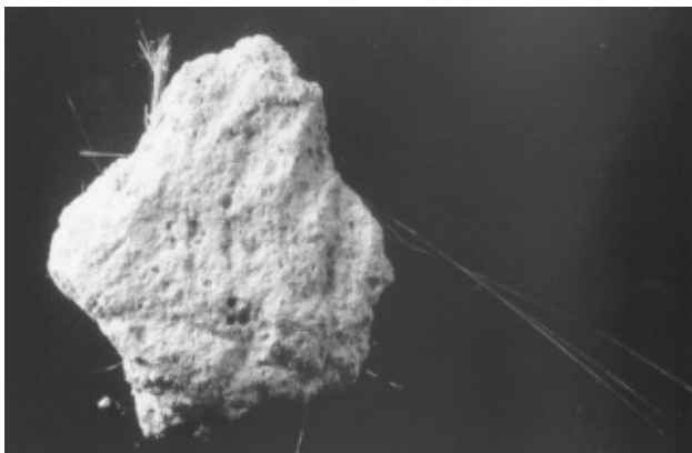
Malta di un'isolazione di tubazioni contenente amianto con ciuffi di fibre d'amianto ben visibili, foto: SA
