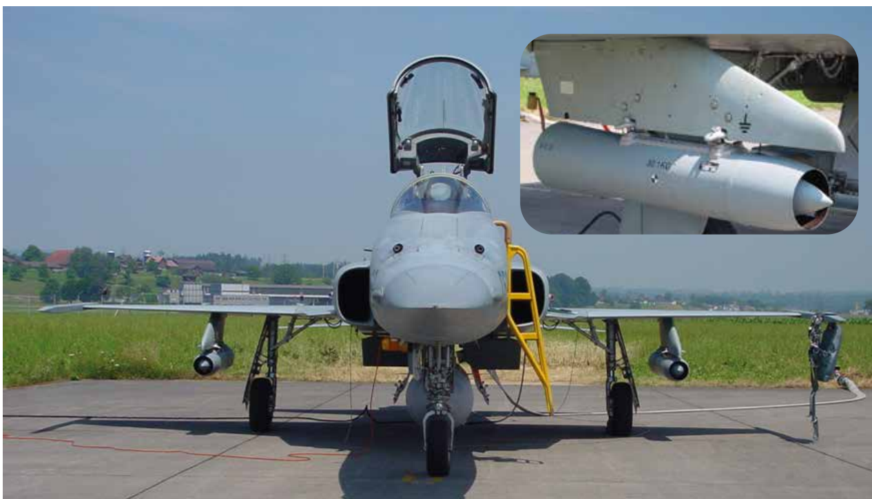
Figur 2 : Höhenluftfilter-Aggregate montiert an den beiden Flügeln eines Tiger und Detail-Aufnahme eines Sammelgerätes.
