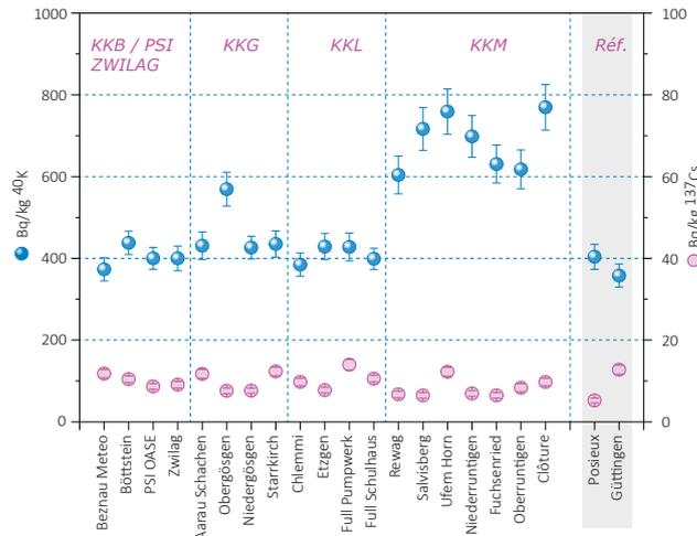
**Figure 3:**  $^{137}\text{Cs}$  et  $^{40}\text{K}$  (naturel) dans les sols secs et tamisés (2mm) analysés par l'OFSP en 2022 (couche 0-5 cm). Les valeurs mesurées à Posieux et Güttingen sont représentées à titre de comparaison (grisées).
