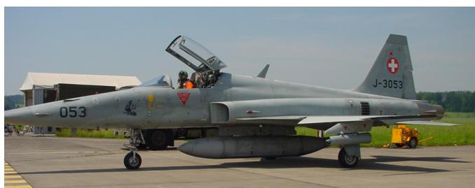
**Figuren 4 bis 9:** Höhenluftfilter-Aggregate montiert an den beiden Flügeln eines Tiger (F5E/F)-Flugzeuges der Schweizer Luftwaffe auf dem Militärflugplatz Payerne sowie Detail-Aufnahmen (von vorne und hinten) eines Sammelgerätes.
