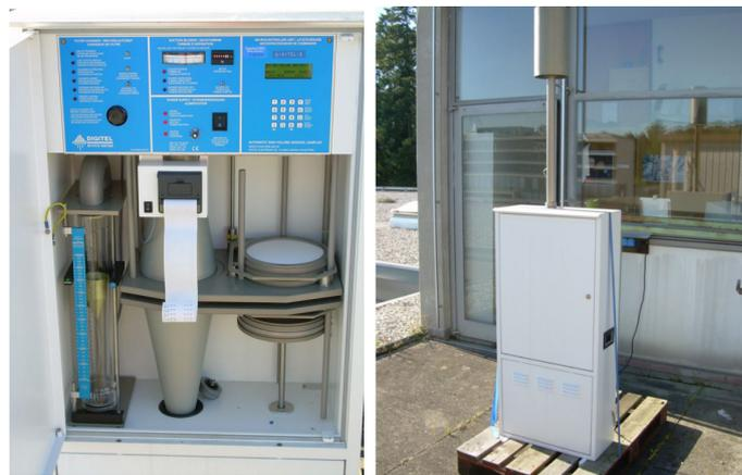
Figur 4: DIGITEL DHA-80 Aerosol-Sammler: linkes Bild Gerät geöffnet: links Rotameter für die Durchflussregelung, Mittel Bestäubungseinheit und rechts Filterstapel, leere Filter oben und beladene Filter unten.
