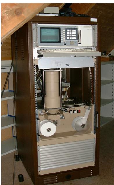
**Photo 4: Station RADAIR de Sion (VS): Moniteur Alpha-Beta (FHT-59s)**
