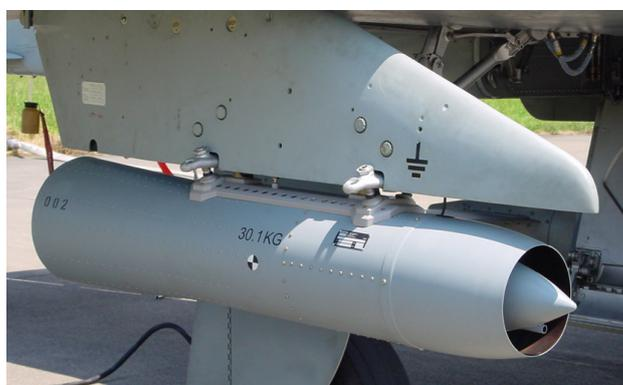
**Figuren 4 bis 9: Höhenluftfilter-Aggregate montiert an den beiden Flügeln eines Tiger (F5E/F)-Flugzeuges der Schweizer Luftwaffe auf dem Militärflugplatz Payerne sowie Detail-Aufnahmen (von vorne und hinten) eines Sammelgerätes.**
