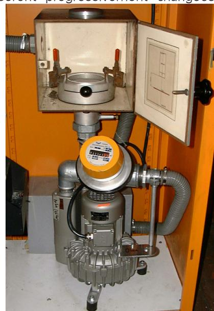
Photo 2: Collecteur d'aérosols de Locarno-Monti: boîte à filtres ouvertes, dessous mesure du débit et pompe
