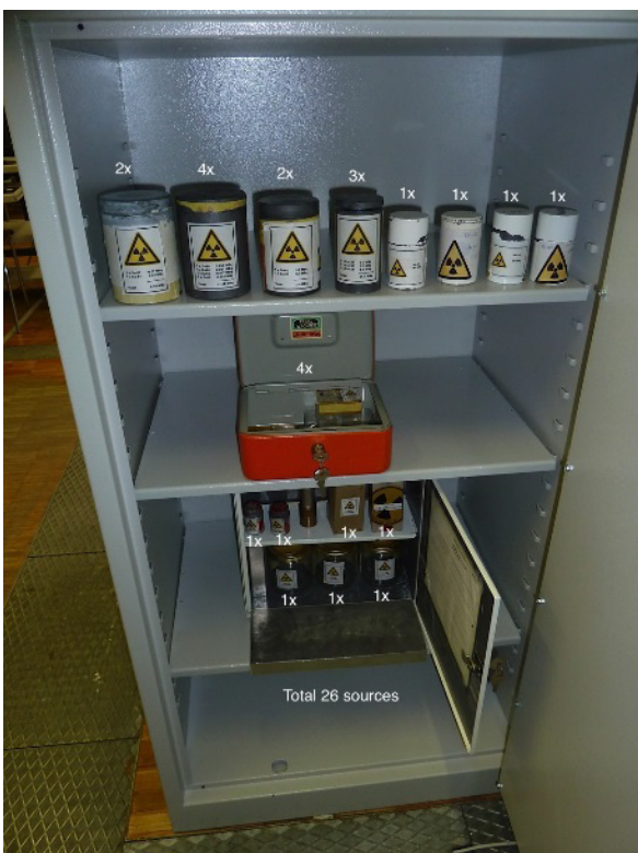
Figure 2: Marquage des sources radioactives : le symbole de danger ainsi que les informations sur le nucléide et l'activité permettent l'identification rapide des sources. Un système afin de constater rapidement l'absence d'une source doit être mis en place.
