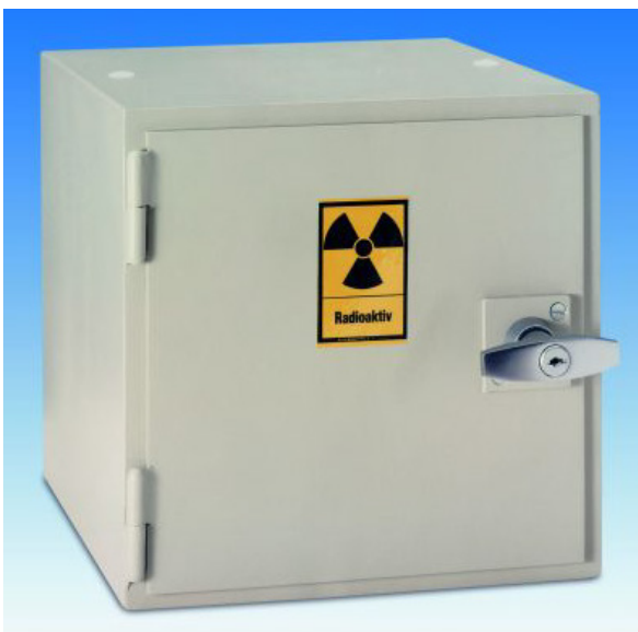
Figure 1: Coffre-fort simple pour le stockage de sources radioactives assurant la protection contre le feu et le vol. L'accès au coffre ne doit être permis qu'à un nombre restreint de personnes. Le coffre doit être marqué du signe de danger.
