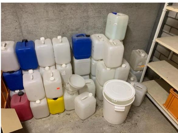
**Figure 12 :** Accumulation et stockage non conforme dans un local déchets d'une université (indications manquantes, sans bacs de récupération, surfaces poreuses en contact avec les déchets...)
