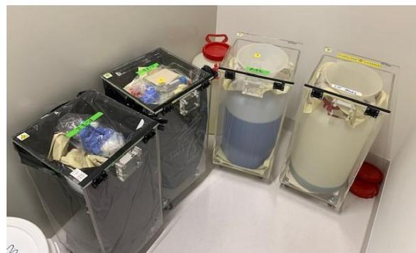
**Figure 11** : Stockage pour décroissance de déchets solides et liquides d'un laboratoire de recherche. Les conteneurs pour déchets liquides sont placés dans des bacs de rétention.
