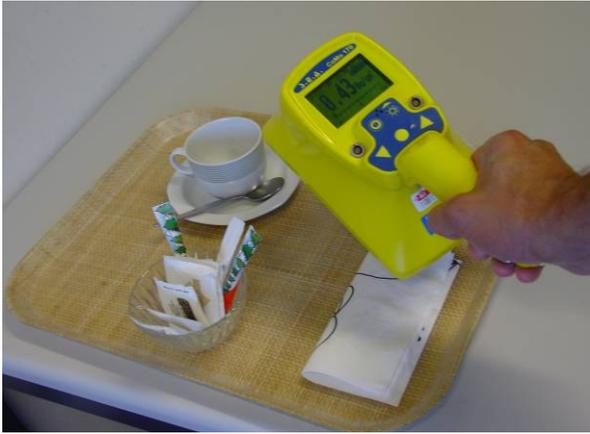
Fig.2 Mesure de la contamination de la vaisselle
