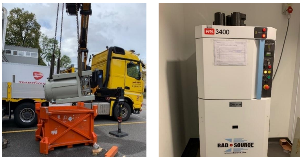
Figure 2 : Exportation d'un équipement d'irradiation du sang au césium (à gauche). L'équipement de plusieurs tonnes contenant la source radioactive de haute activité est déposé dans le conteneur servant au transport. Son élimination coûte environ cent mille francs à l'heure actuelle, tendance à la hausse. Photo de droite : un appareil à rayons X équivalent installé en remplacement. Il exclut la menace d'utilisation abusive et ne nécessite donc aucune mesure de sécurisation supplémentaire contre le vol ou le sabotage. Son élimination est aussi nettement moins coûteuse.
