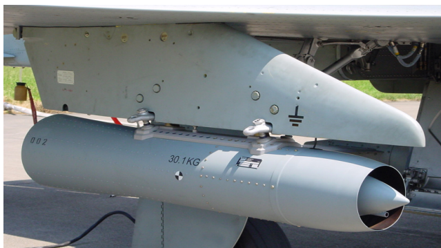
Figur 2 : Höhenluftfilter-Aggregate: Detail-Aufnahme eines Sammelgerätes.
