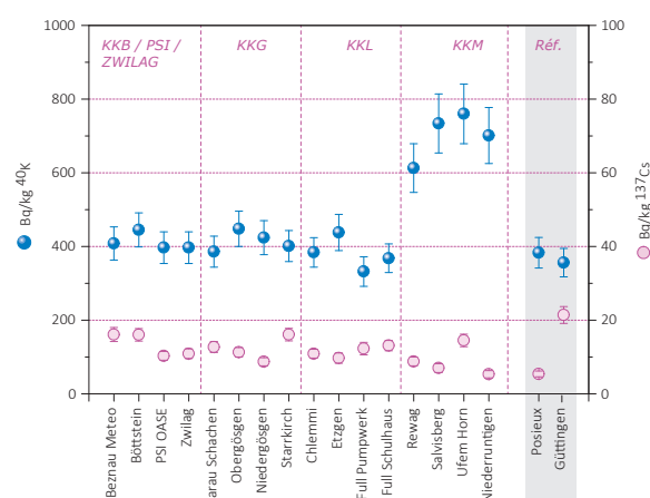
Figure 3: ^{137}\text{Cs} et ^{40}\text{K} (naturel) dans les sols secs et tamisés (2mm) analysés par l'OFSP en 2016 (couche 0-5 cm). Les valeurs mesurées à Posieux et Güttingen sont représentées à titre de comparaison (grisées).
