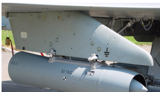
Figur 2: Höhenluftfilter-Aggregate montiert an den beiden Flügeln eines Tiger sowie Detail-Aufnahme eines Sammelgerätes.
