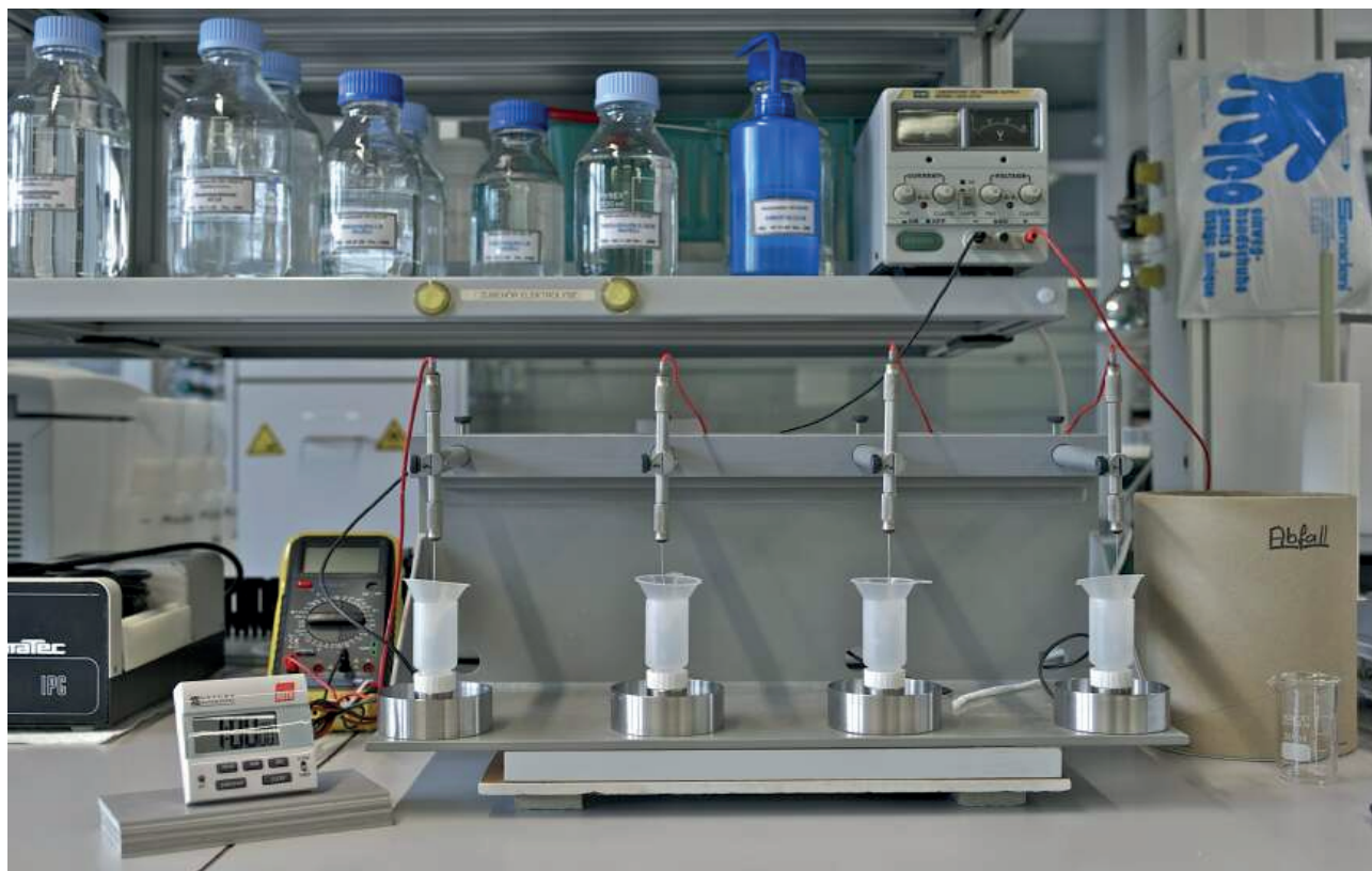
Figur 1: Verwendete Elektrolyse-Apparatur am PSI.
