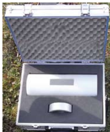
Figur 9: Set für Sondentest: Plastikzylinder, Quelle.
