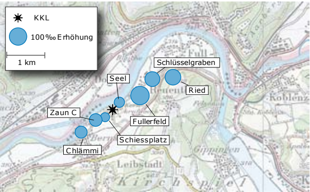
Figur 2: Netto \Delta^{14}\text{C} -Messwerte in der Umgebung des Siedewasserreaktors Leibstadt (KKL). Probennahme: 12.8.2009. Die Kreisflächen sind proportional der Erhöhung gegenüber den unbelasteten Referenzstationen.
