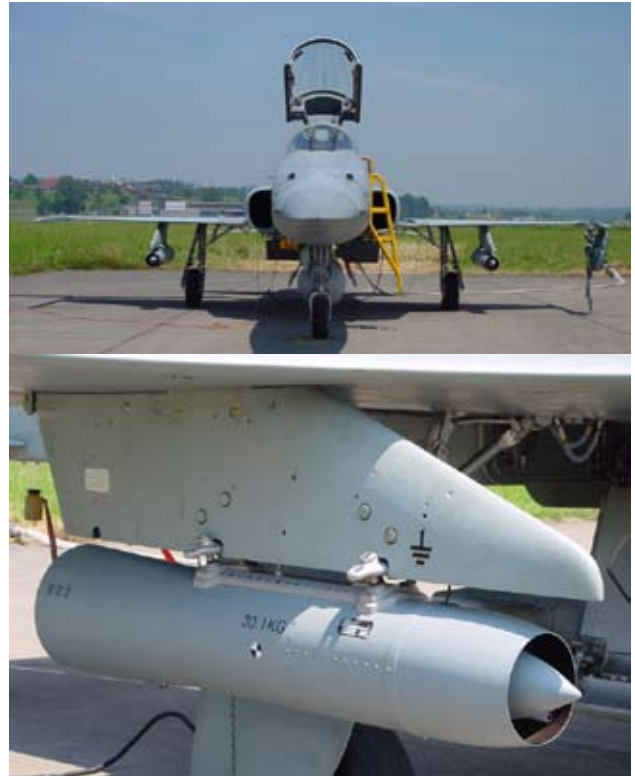
Figur 2 und 3: Höhenluftfilter-Aggregate montiert an den beiden Flügeln eines Tiger sowie Detail-Aufnahme eines Sammelgerätes.
