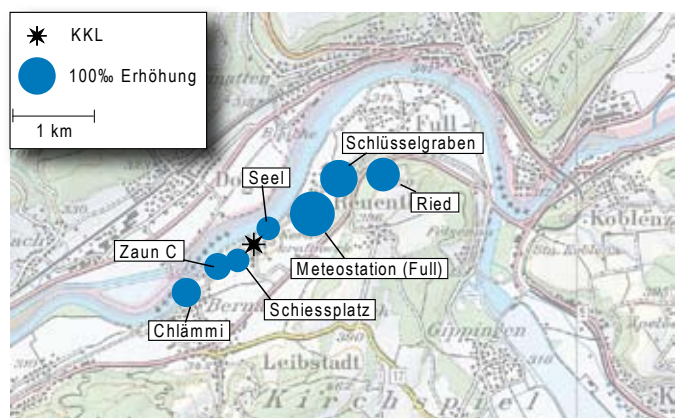
Figur 5: Netto \Delta^{14}\text{C} -Messwerte in der Umgebung des Siedewasserreaktors Leibstadt (KKL). Probennahme: 28. Juli 2008. Die Kreisflächen sind proportional der Erhöhung gegenüber den unbelasteten Referenzstationen.
