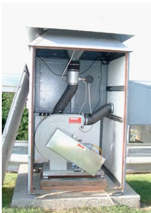
Photo 3: Collecteur d'aérosols à grand débit de Güttingen/TG (500 à 700 m³/h; type ASS-550)
