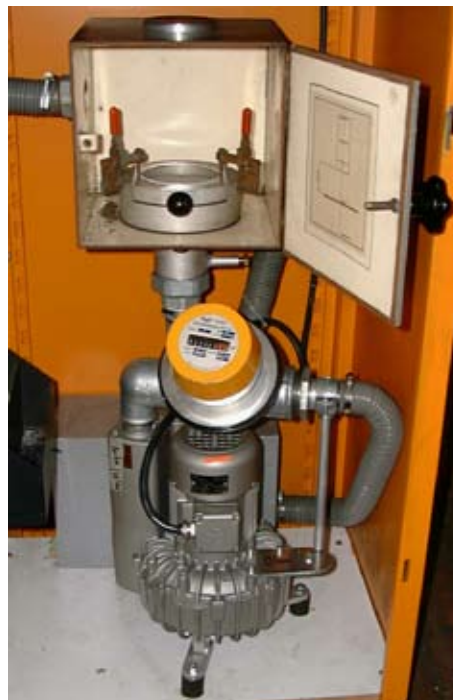
Photo 2: Collecteur d'aérosols de Locarno-Monti: boîte à filtres ouvertes, dessous mesure du débit et pompe
