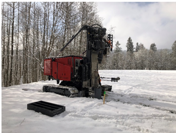
Abbildung 2: Beispiel einer Bohrlochsondierung. Alles mit Radium kontaminiertes Material sollte, wenn möglich, wieder im Bohrloch deponiert werden.
