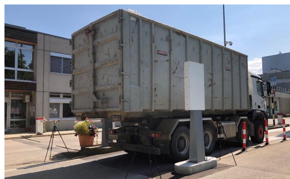
Abbildung 6: Messportal für die Überprüfung von grossen Mengen an Material.
