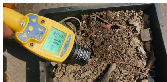
Abbildung 5: Messung von Aushubmaterial von Hand mit einem Dosisleistungsmessgerät. Kann auch zur Lokalisierung von radioaktivem Material verwendet werden.
