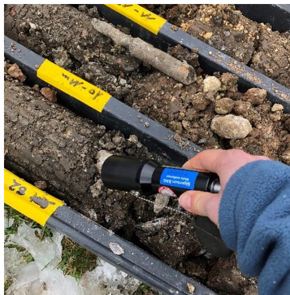
Abbildung 3: Messung der Zählrate mit einer kleinen Kontaminationsmesssonde.
